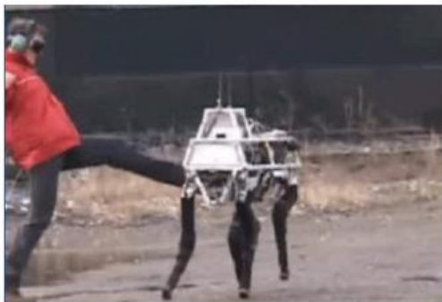
couple de renversement du robot BigDog
