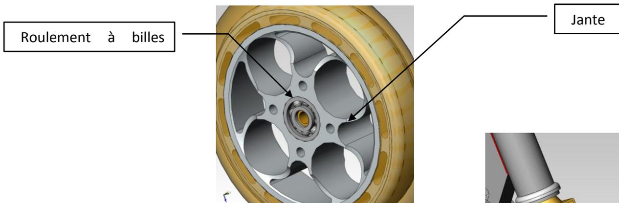
Au final, l'assemblage roue sur fourche doit vous donner le résultat suivant, avec la rotation de la roue possible
