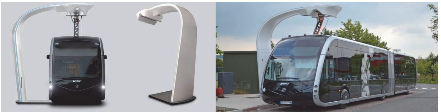
Figure 2 : bus NEMO avec le pantographe déployé
