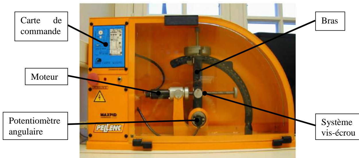
Figure 8 : Chaîne fonctionnelle du robot Maxpid
