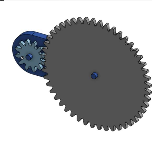
Placez les liaisons pivot
