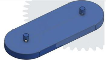
Les deux roues sont superposées. Il faut les décaler pour que la distance entre les centres des roues soit égale à la somme des rayons primitifs.
