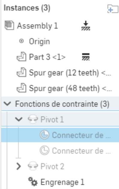
Double-cliquer sur connecteur de position pour ouvrir la fenêtre de dialogue.
