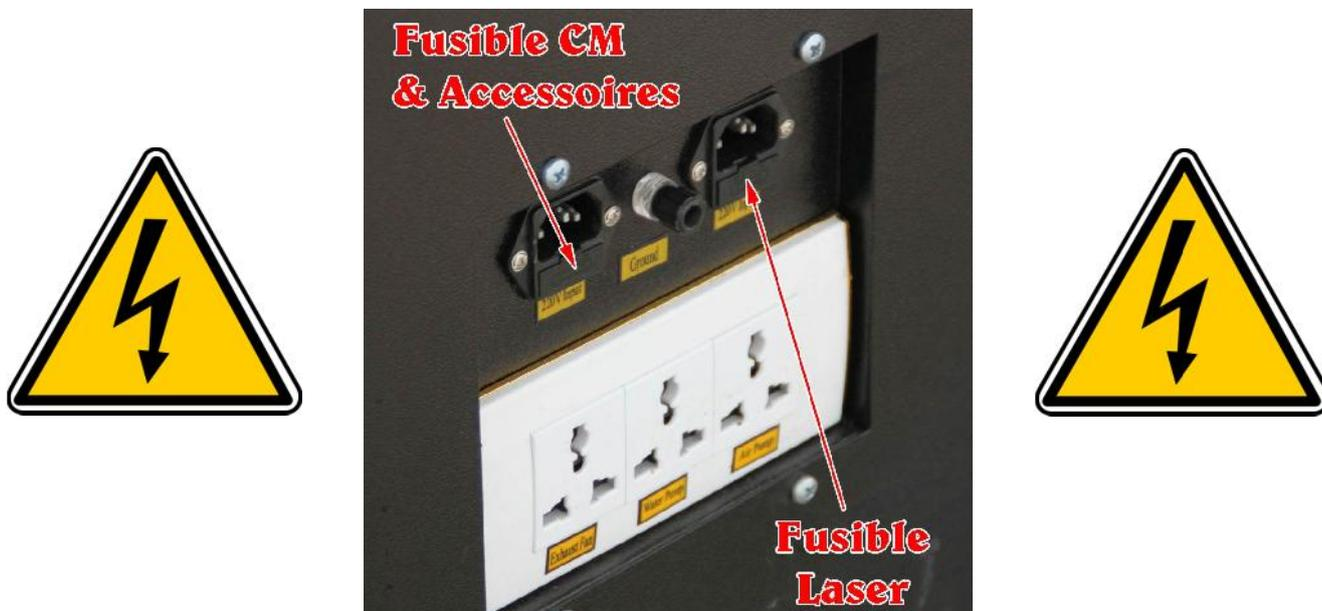
Il faut également connecter l'extracteur d'air (ou le filtre à charbon actif) ainsi que le compresseur d'air sur les prises blanches "Accessoires" qui se situe sous les prises d'alimentation machine (voir photo ci-dessus).
