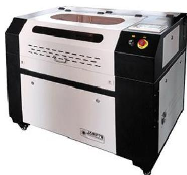
La découpe laser JA-60 a été spécialement conçue pour avoir la plus grande surface de travail possible tout en étant capable de passer par des portes de largeur standard. Sa puissance de 60W, son autofocus et son axe Z mobile permettent de découper/graver des objets ayant une hauteur jusqu'à 150mm.
