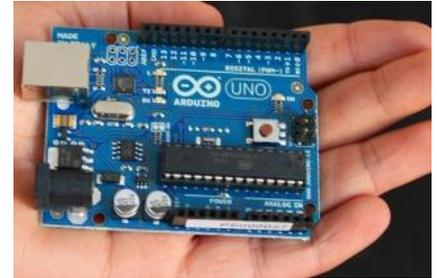
Les cartes Arduino permettent de traiter des données provenant de composants et capteurs divers (capteur de température, luminosité, mouvement ou boutons-poussoirs, ...) et de communiquer des ordres pour allumer des lampes ou actionner des moteurs électriques, par exemple.
