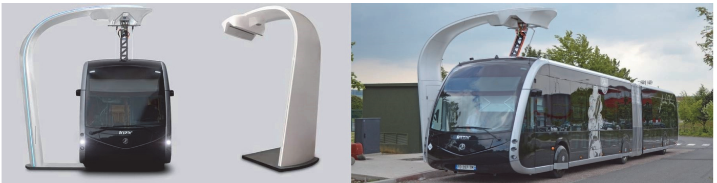
Figure 2 : bus NEMO avec le pantographe déployé
