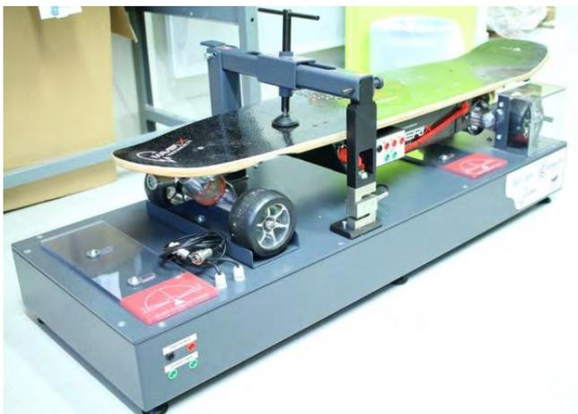
Le banc de test du skate électrique permet de mesurer directement différentes tensions et intensités :
