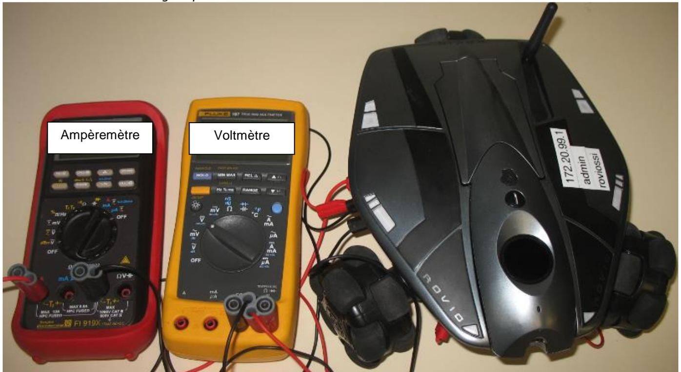
**Q15** : Proposer un protocole expérimental permettant de mesurer la puissance consommée par le Rovio en fonctionnement. **On se limitera à la marche avant, à vitesse maximale.**
