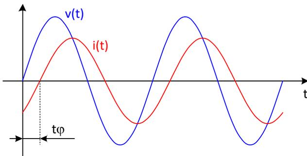
Certains appareils génèrent un décalage temporel entre le courant et la tension. Ce décalage temporel est appelé déphasage.
