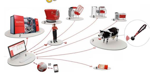
Une exploitation agricole de vache laitières dispose d'une mise en réseau des différents outils de la ferme : robots de traite des vaches, robots de distribution de l'alimentation, barrières, colliers d'identification des animaux, gestion de l'éclairage, ....
