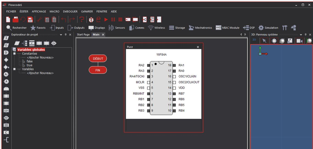
Dans ce premier exercice nous allons réaliser un programme qui permet d'allumer une diode en agissant sur un interrupteur bistable.
