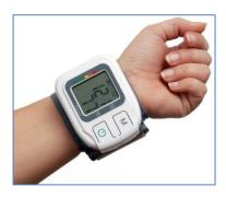
Une fois le brassard enroulé autour du poignet, l'appui sur le bouton POWER active le compresseur. La mise en pression se fait progressivement jusqu'à la consigne de pression *PB*. Lors du dégonflage du brassard, la diminution de la pression est assurée par l'électrovanne de décharge à vitesse contrôlée afin d'effectuer la mesure de la pression artérielle. Cette électrovanne permet le dégonflage de la poche lorsqu'elle est activée.
