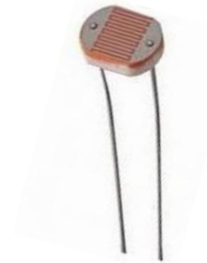
Les résistances dépendant de la lumière sont deux cellules photoconductives en sulfure de cadmium (CdS) avec des réponses similaires à celles de l'œil humain. La résistance des cellules diminue avec l'intensité de la lumière.
