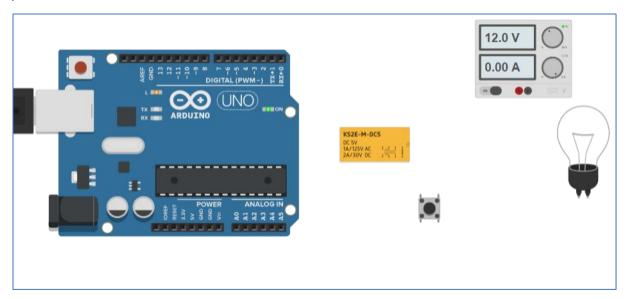
Q2) Compléter le schéma électrique (respecter les couleurs de fils : rouge=alimentation, noir=masse, vert=information) pour que l'ampoule s'allume lorsque la luminosité (acquisition sur broche A0) dépasse le seuil de 500. Le pilotage du relais se fera à partir de la broche 3.
