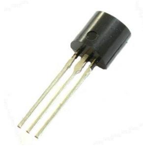
Le transistor est un composant électronique qui est utilisé dans la plupart des circuits électroniques (circuits logiques, amplificateur, stabilisateur de tension, modulation de signal, etc.) aussi bien en basse qu'en haute tension.
