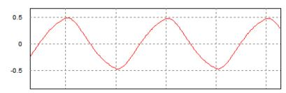
Filtrage passe-bas. Il ne laisse passer que le fondamental : une sinusoïde de même fréquence que le signal carré.
