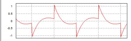
Filtrage passe-haut. Ce filtre ne réagit que lorsque le signal carré varie rapidement, ici sur les fronts, ce qui génère les pics visibles sur le signal.
