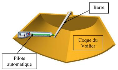
Le contrôle de la barre est assuré par un système mécanique associé à un actionneur électrique. La société a retenu pour cela un moteur à courant continu (**RS-755 SH MITSUBISHI**).
