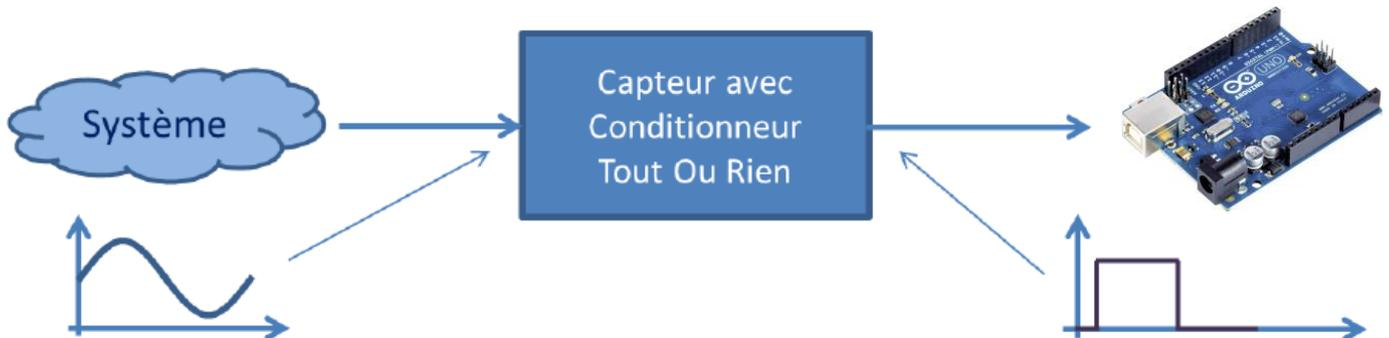
Dans la pratique, le capteur TOR possède deux seuils distincts afin d'éviter que la sortie ne devienne instable lorsque l'entrée est très proche du seuil. Pour que la sortie du capteur passe à l'état haut, il faut que la grandeur d'entrée passe au-dessus du seuil haut.
