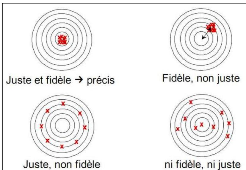
**Justesse** : un capteur est juste si ses valeurs ne changent pas quand on les compare à des valeurs étalon ou à des valeurs données par d'autres capteurs normalisés.
