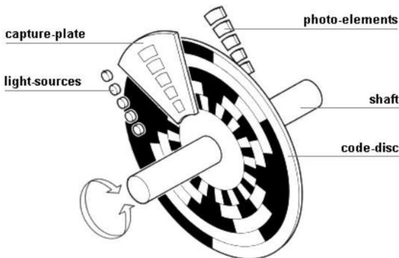
En fonction de la position du disque, chaque détecteur renvoie une information binaire. Le code formé par l'ensemble des détecteurs indique la position angulaire de l'axe du capteur.
