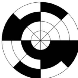
Le codage en binaire naturel présente l'inconvénient de faire apparaître des états transitoires erronés, lors du passage d'un secteur à l'autre, lorsque les capteurs ne sont pas parfaitement alignés
