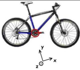
on s'intéresse à la liaison du pédalier avec le cadre
