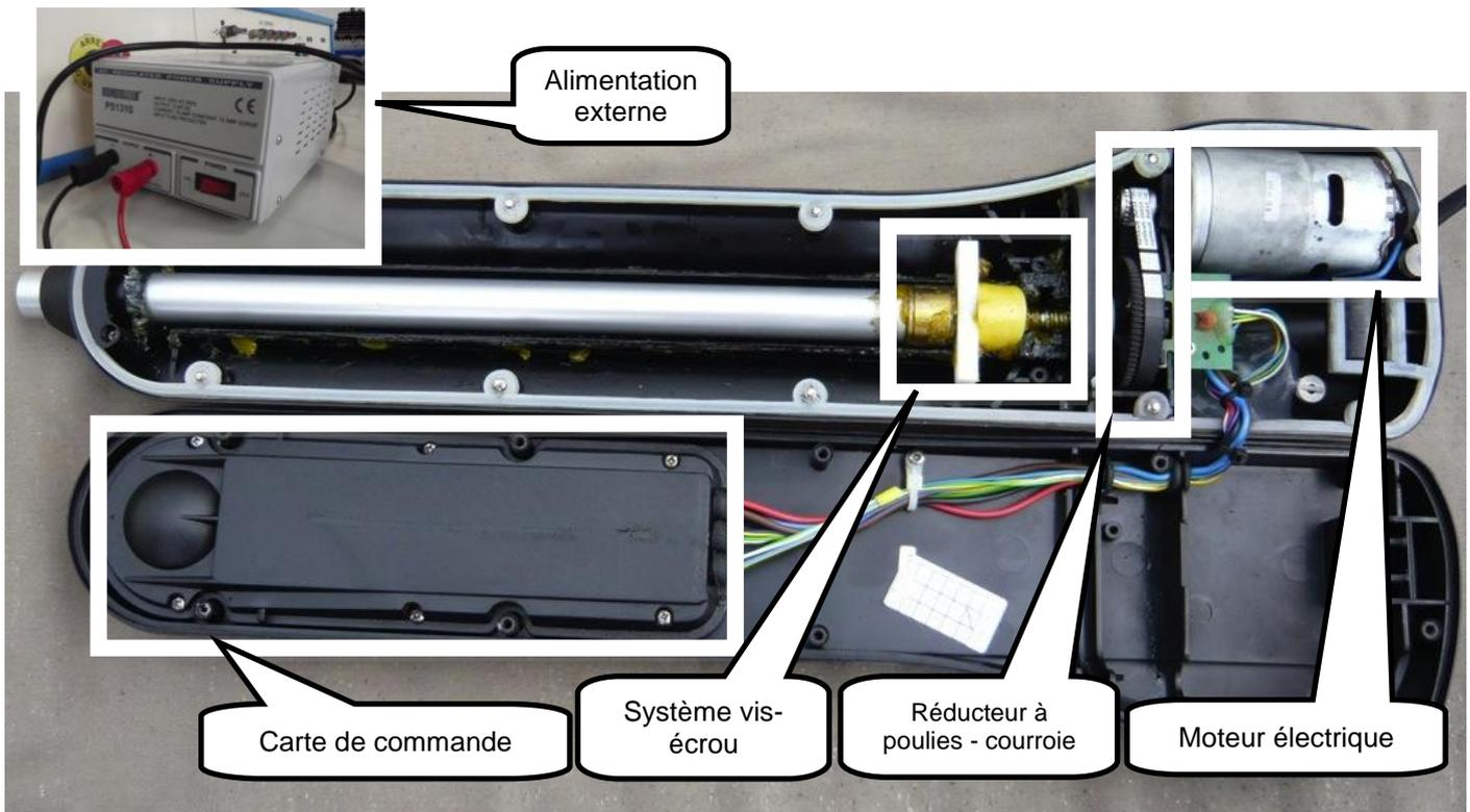
Q1. Compléter la chaîne d'énergie ci-dessous en indiquant le nom de l'organe réalisant la fonction en dessous des blocs :
