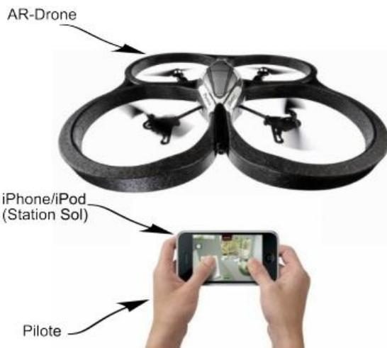
Un **drone** ou UAV (Unmanned Aerial Vehicle) est un aéronef inhabité, piloté à distance, semi-autonome ou autonome, susceptible d'emporter différentes charges utiles le rendant capable d'effectuer des tâches spécifiques pendant une durée de vol pouvant varier en fonction de ses capacités.
