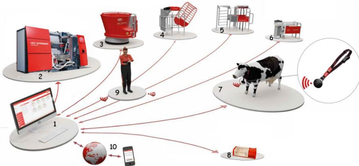
Une exploitation agricole de vache laitières dispose d'une mise en réseau des différents outils de la ferme : robots de traite des vaches, robots de distribution de l'alimentation, barrières, colliers d'identification des animaux, gestion de l'éclairage, ....
