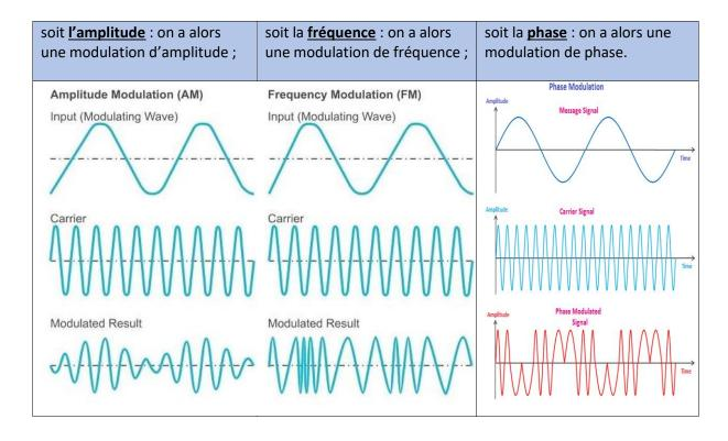
Dans la modulation analogique, le signal analogique (signal sinusoïdal) est utilisé comme un signal porteur qui module le signal de message ou le signal de données. La fonction générale d'une onde sinusoïdale est illustrée dans la figure ci-dessous. Trois paramètres peuvent être modifiés pour obtenir une modulation : l'amplitude, la fréquence et la phase ; les types de modulation analogique sont donc les suivants :
