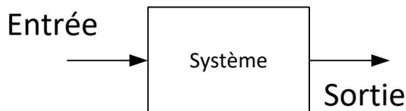
Exprimer l'entrée de notre système en fonction de la sortie, et la mettre sous la forme canonique  $K \cdot e(t) = s(t) + \tau \frac{ds(t)}{dt}$
