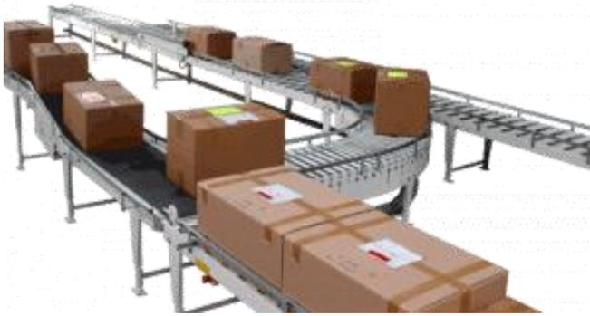
Le tapis roulant est mis en mouvement par des rouleaux de 5cm de rayon. Le rouleau qui entraîne le tapis est mis en rotation par un moteur électrique associé à un réducteur à engrenages.
