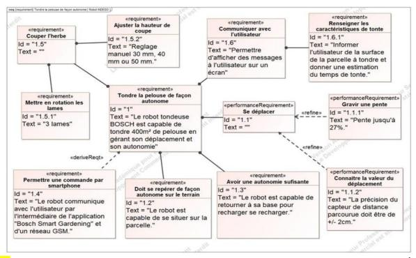
**Q1** : Lire, sur le diagramme des exigences, la pente maximale que peut grimper le robot tondeuse. À partir de la Figure 1.6, calculer l'angle de cette pente en degrés.
