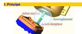
La liaison mécanique permanente entre un arbre moteur et un récepteur peut être assurée par un accouplement. C'est-à-dire un mécanisme qui accepte et compense les défauts géométriques entre les deux arbres.
