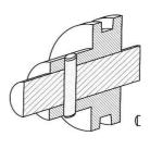
Une solution constructive consiste à intercaler entre l'arbre moteur et l'arbre récepteur une pièce qui supporte le couple à transmettre. Cette pièce est dimensionnée pour se rompre lorsque le couple limite est atteint. Cette pièce, généralement une goupille, est parfois appelée « fusible mécanique ».
