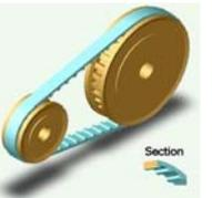
Les poulies crantées et la courroie associée assurent une transformation de mouvement sans glissement. Comme les engrenages, cette transformation de mouvement est par obstacle, donc avec conservation des positions relatives des poulies à tout instant.
