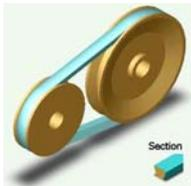
Les courroies à section circulaire, trapézoïdale, rectangulaire assurent une transmission de mouvement avec glissement. Cela peut être utilisé comme une sécurité sur le système : limiteur de couple.
