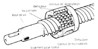
1 tour de la vis par rapport à l'écrou donne un déplacement de la valeur du pas de la vis par rapport à l'écrou.
