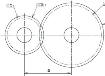
Un engrenage est un ensemble de roues qui engrènent ensemble. C'est une transmission par obstacles.
