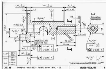
**Le dessin de définition** définit complètement chaque pièce du mécanisme. Ce dessin sert à la fabrication de la pièce. Il y a toutes les cotes de la pièce et toutes les indications pour les usinages.
