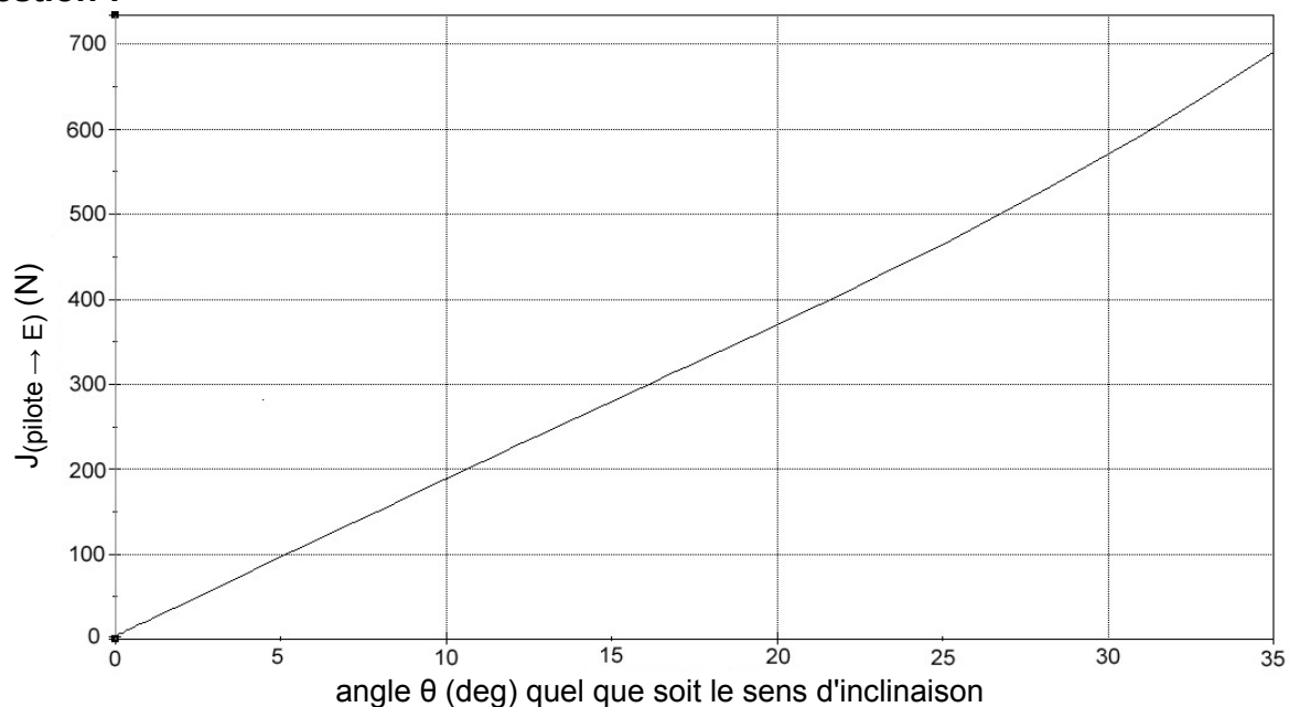
Figure 23 : effort de relevage en fonction de l'inclinaison du Tri'Ode
