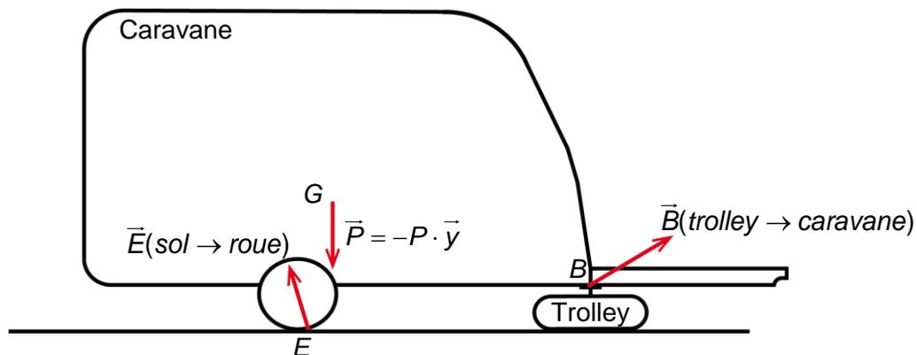
Le principe fondamental de la statique (PFS) appliqué à l'ensemble isolé donne en projection :
