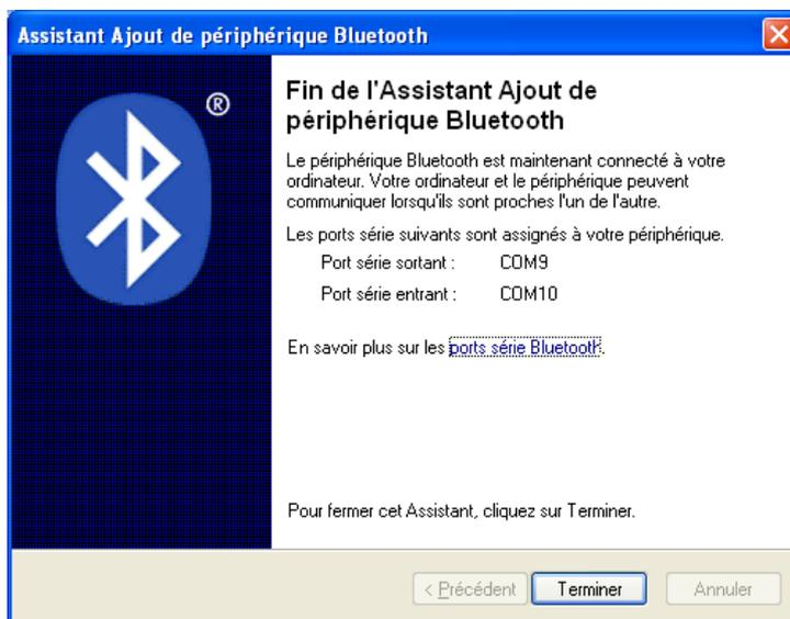
Lancer maintenant HyperTerminal et utiliser le port COM9 pour envoyer des données. Dès que vous êtes connecté, une DEL verte s'allume sur l'EBlock. A chaque caractère envoyé à l'aide d'HyperTerminal, la DEL bleue du module USB-Bluetooth clignote.
