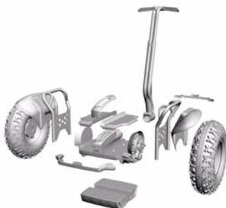
**Figure 27. Schéma des pièces du Segway TP (modèles i2, x2)**
