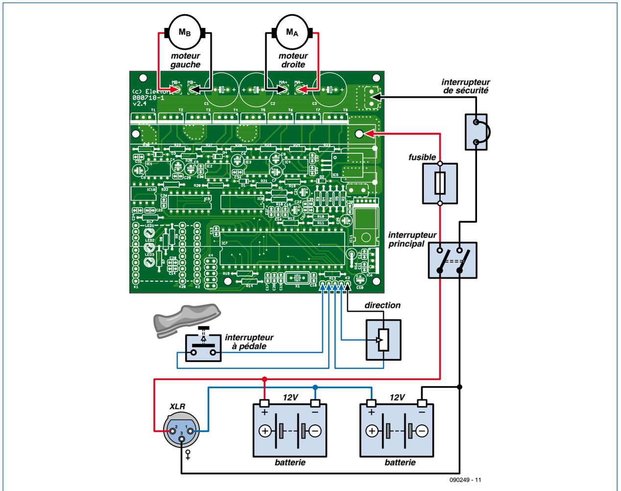
Le schéma de câblage vous montre comment tous les composants doivent être reliés entre eux. Faites surtout attention à la polarité des accumulateurs et au raccordement des moteurs (ne permutez pas le gauche et le droit).
