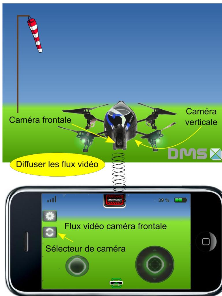
Fig. 19: Diffusion des flux vidéo de l'AR.Drone sur la Station-Sol
