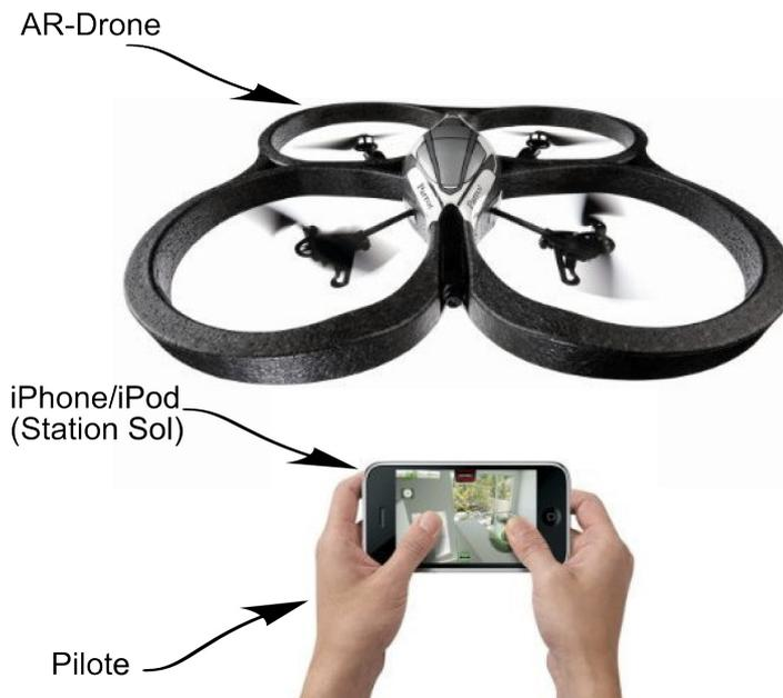
Fig. 12: Système AR.Drone
