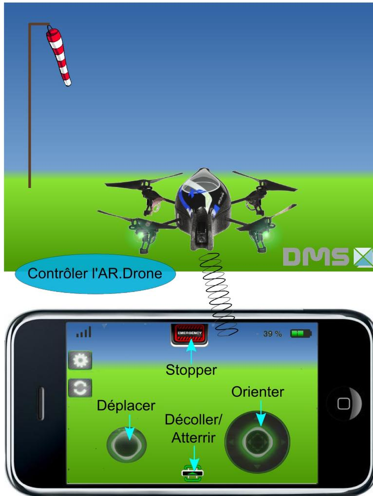
Fig. 17: Interface de contrôle de l'AR.Drone sur la Station-Sol
