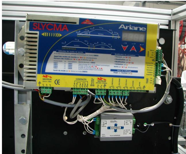
Le profil de vitesse (« graphe des vitesses ») est programmable par l'utilisateur.
