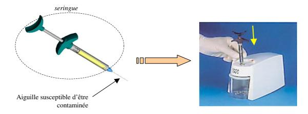
L'arrivée de la seringue dans le mécanisme est détectée par un capteur à infrarouge. L'embase est découpée par cisaillement grâce à un système de lames coupantes :
