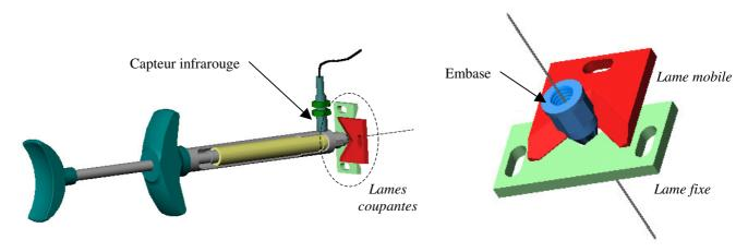
Une fois coupée, l'aiguille usagée est récupérée dans un container de sécurité afin d'être décontaminée puis recyclée :
