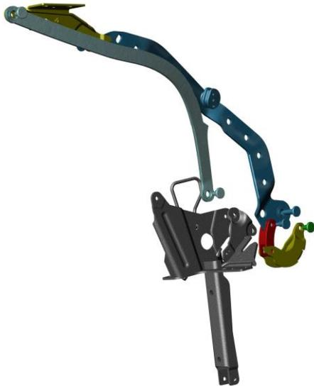
L'étude a pour but de valider le choix du matériau d'une pièce du mécanisme permettant de mettre en mouvement le toit escamotable de la 206CC du constructeur Peugeot.
