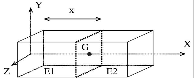
Les efforts de cohésion traduisent les actions de contact de (E2) sur (E1). Ces efforts de cohésion permettent à la poutre de ne pas se "disloquer" sous l'effet d'actions extérieures.
