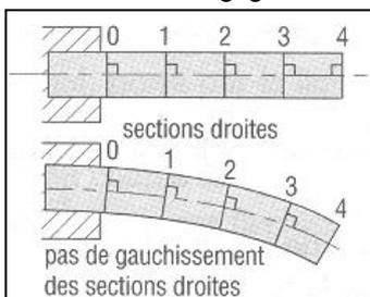
**Navier & Bernoulli** : Les sections planes normales aux fibres avant déformation demeurent planes et normales aux fibres après déformation.
