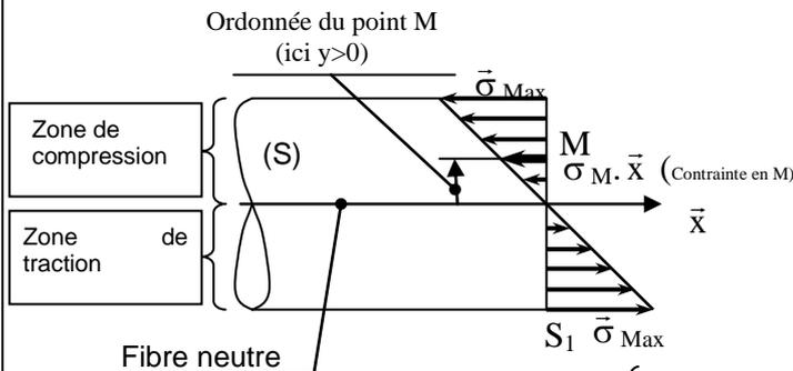
La loi de Hooke a permis de mettre en évidence que la contrainte est proportionnelle à allongement relatif. Dans le cas de la flexion plane simple, les contraintes se réduisent essentiellement à des contraintes normales.
