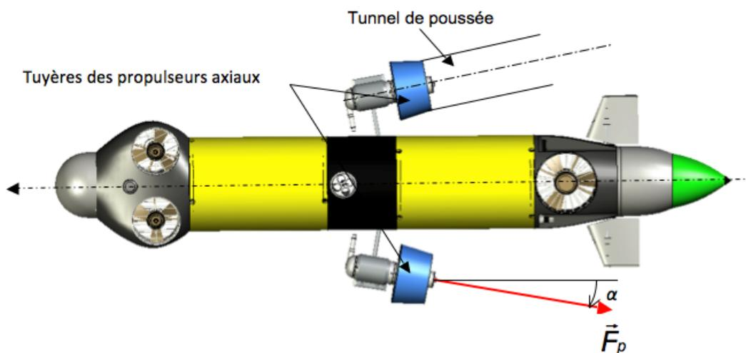
**Q3.** Les propulseurs axiaux sont inclinés par rapport à l'axe de l'engin afin de limiter les perturbations. **Déterminer** la force de poussée (dans l'axe de l'engin)  $\|\vec{F}_P\|$  d'un propulseur. En consultant la documentation technique du constructeur (DT3), **évaluer** et **commenter** l'écart entre cette force de poussée et celle annoncée par le constructeur.
