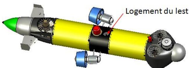
L'engin ne possède pas de ballast (possibilité de remplir de fluide des compartiments). Le réglage de la flottabilité de l'appareil à une profondeur donnée est réalisé grâce à l'insertion d'une masse (lest) dans un logement prévu à cet effet. Un dispositif de largage de cette masse
