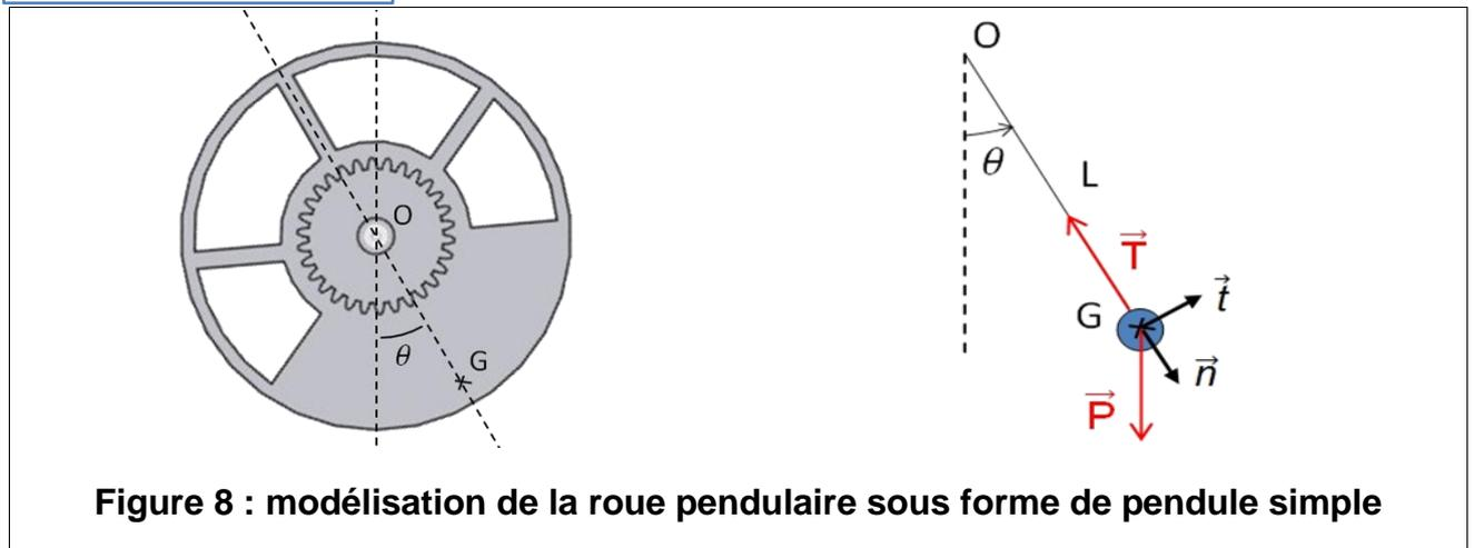
Figure 8 : modélisation de la roue pendulaire sous forme de pendule simple
