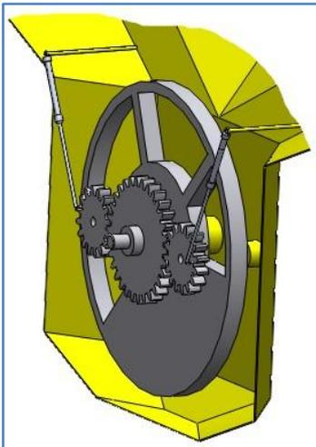
La roue pendulaire, que l'on peut assimiler à un cylindre à centre d'inertie excentré, se comporte mécaniquement comme un pendule simple composé d'une bille de masse  $m$  et un fil de longueur  $L$ .
