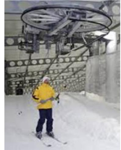
Le site est équipé d'une remontée mécanique de type téléski. Elle permet aux skieurs de remonter la piste à partir de la zone de chargement située en bas de la piste jusqu'à la zone de lâché en haut de la piste. Le téléski est constitué d'un câble tracteur et d'agrès. Le câble tracteur est entraîné par une poulie motrice et parcourt la piste dans sa longueur.
