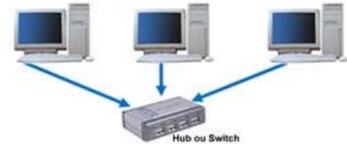
Ce type de réseau est facile à mettre en place et à surveiller. La panne d'une station ne met pas en cause l'ensemble du réseau. Par contre, il faut plus de câbles que pour les autres topologies, et si le concentrateur tombe en panne, tout le réseau est hors d'état de fonctionner. De plus, le débit pratique est moins bon que pour les autres topologies.
