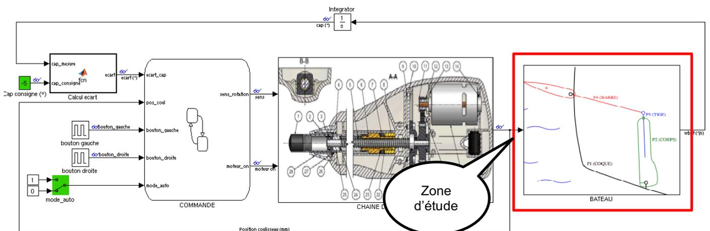
Le pilote agit sur la barre, qui agit sur le safran. On considère que la vitesse de changement de cap  $w_{\text{bateau}}$  en  $^{\circ}/s$  du bateau est proportionnelle à la sortie du coulisseau du pilote. On donne la courbe  $w_{\text{bateau}} = f(\text{position coulisseau})$  :
