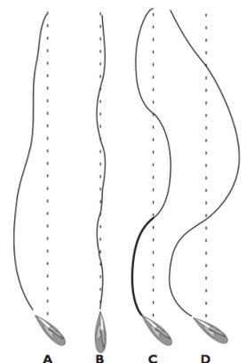
Ce comportement dépend en partie de la programmation du pilote, et plus particulièrement de l'algorithme qui gère le mode automatique de suivi de cap.
