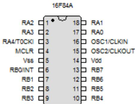
Le **PORTB**, comprend un octet (BYTE) de donnée (DATA) de RB0 à RB7. Chaque bit de cet octet peut être utilisé et configuré comme une entrée (I) ou comme une sortie (O), il est bidirectionnel. Le bit RB0 peut de plus, être utilisé comme un signal d'interruption (INT) externe.
