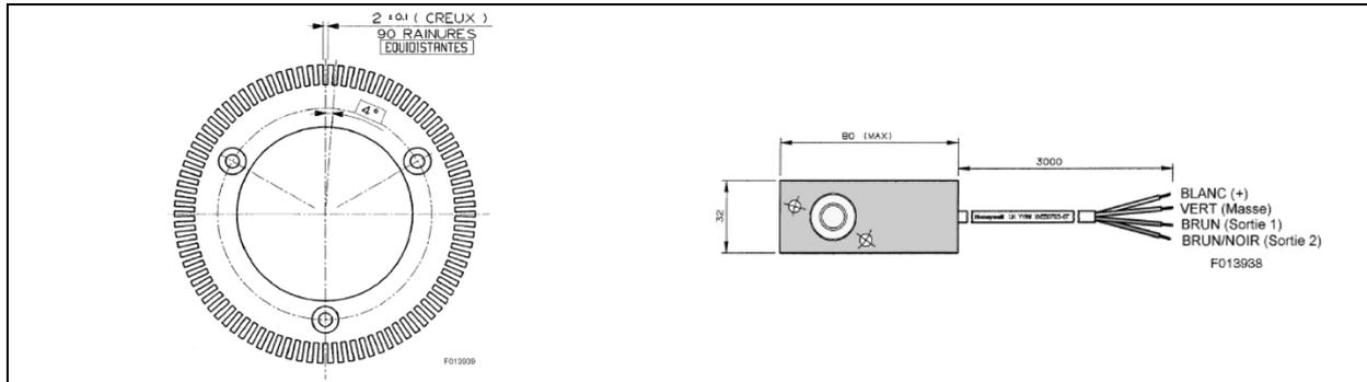
Fig. 1 : capteur de vitesse de rotation
