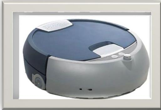
Le robot Scooba lave et sèche le sol de façon autonome.
