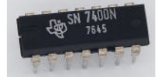
Circuit intégré contenant 4 opérateurs logiques à 2 entrées
